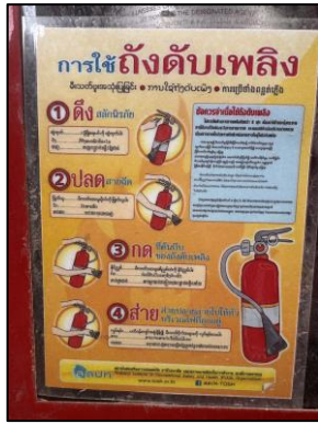
รูปที่ 30 ป้ายแนะนำการใช้ถังดับเพลิง
